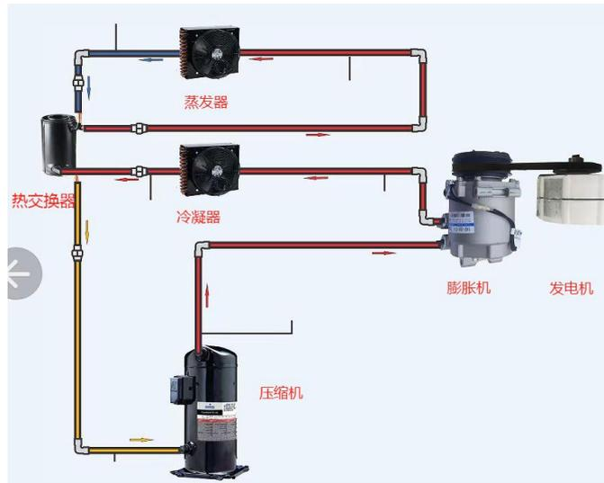
中低温热力发电系统简图
